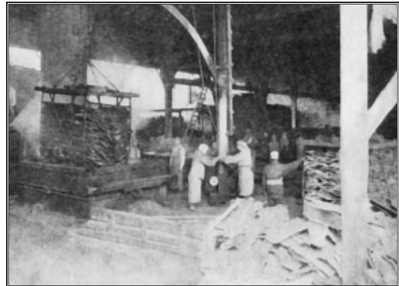
*Fig. 19. — LE BOUILLAGE DU LIÈGE*
